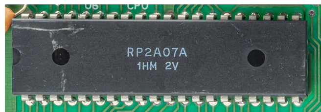
Fig. 8 - La CPU prodotta da Ricoh per il Famicom/ NES, qui in versione PAL (autore: PantheraLeo1359531 - fonte: Wikimedia Commons)
