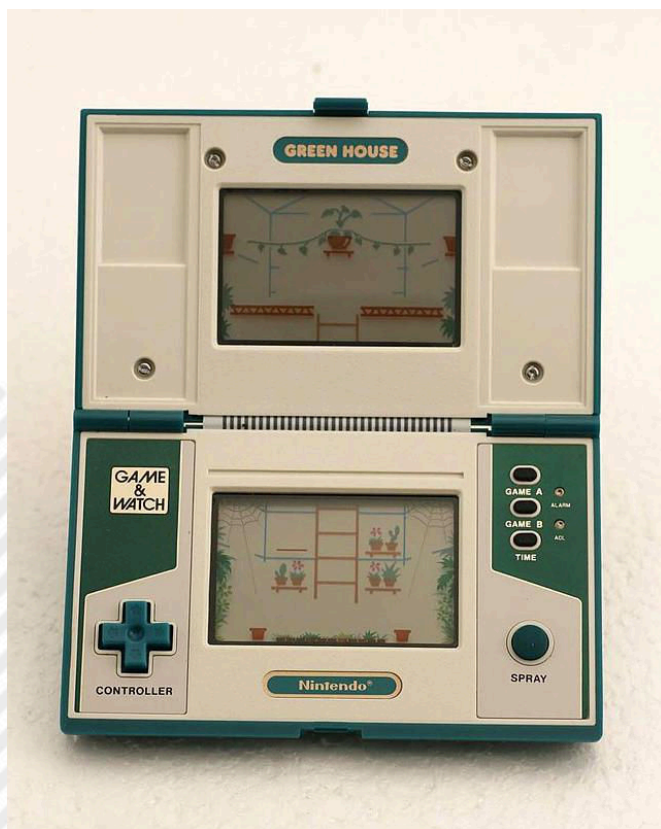
Fig. 6 - Un Game & Watch: da notare il particolare controllo a croce che verrà poi riutilizzato anche nei controller NES/Famicom( autore: Federico Leva - fonte: Wikimedia Commons)
