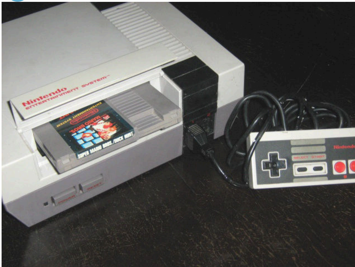
Fig. 11 - Il caricamento delle cartucce sul NES è stato studiato per ricordare quello delle videocassette nei videoregistratori dell'epoca (autore: Yagamichega- fonte: Wikimedia Commons)
